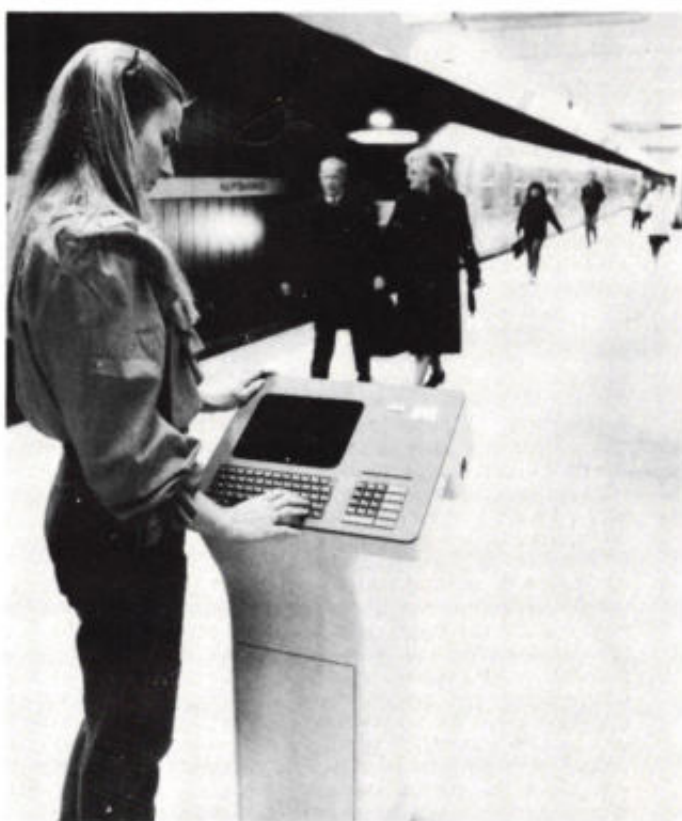
Reiziger in en bezoekers aan Duitsland kunnen nu informatie over o.m. het openbaar vervoer verkrijgen met behulp van een openbare videotex terminal, die wordt geproduceerd door de Duitse ITT-dochter Standard Elektrik Lorenz. Deze terminal is aangesloten op het Duitse viewdatanet. Het systeem is al in gebruik in Berlijn en, bij wijze van proef, in Düsseldorf.
